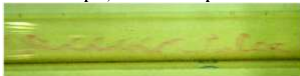
Gambar 5 : Secara Optis, aliran turbulent pada Metode satu aliran
